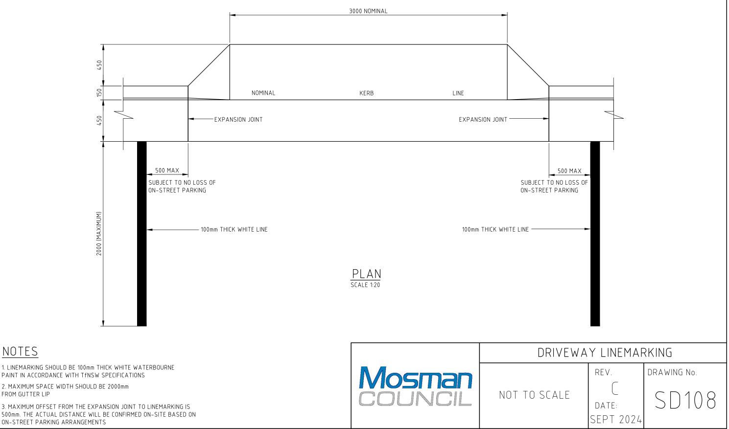
2. MAXIMUM SPACE WIDTH SHOULD BE 2000mm FROM GUTTER LIP
